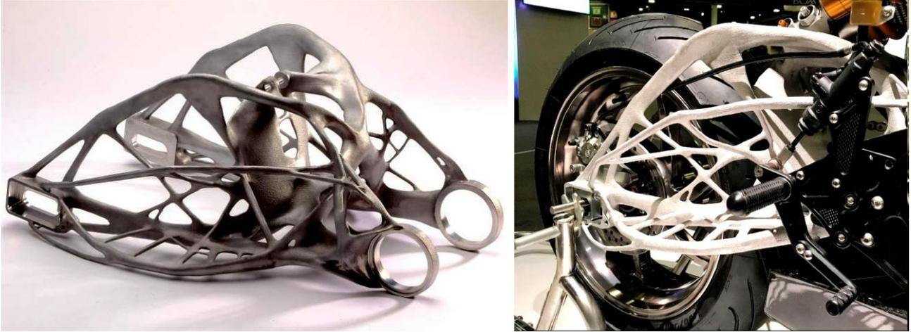
Рис. 1. Маятник (swingarm), общий вид и в конструкции мотоцикла
