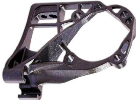
Рис. 2. Суппорт (330×279×152 мм; 7,5 кг) тяжелого грузовика Volvo
