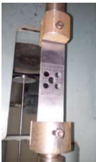
Рис. 4.21. Пластина, встановлена до захватів випробувальної машини з нанесеною мірною сіткою
