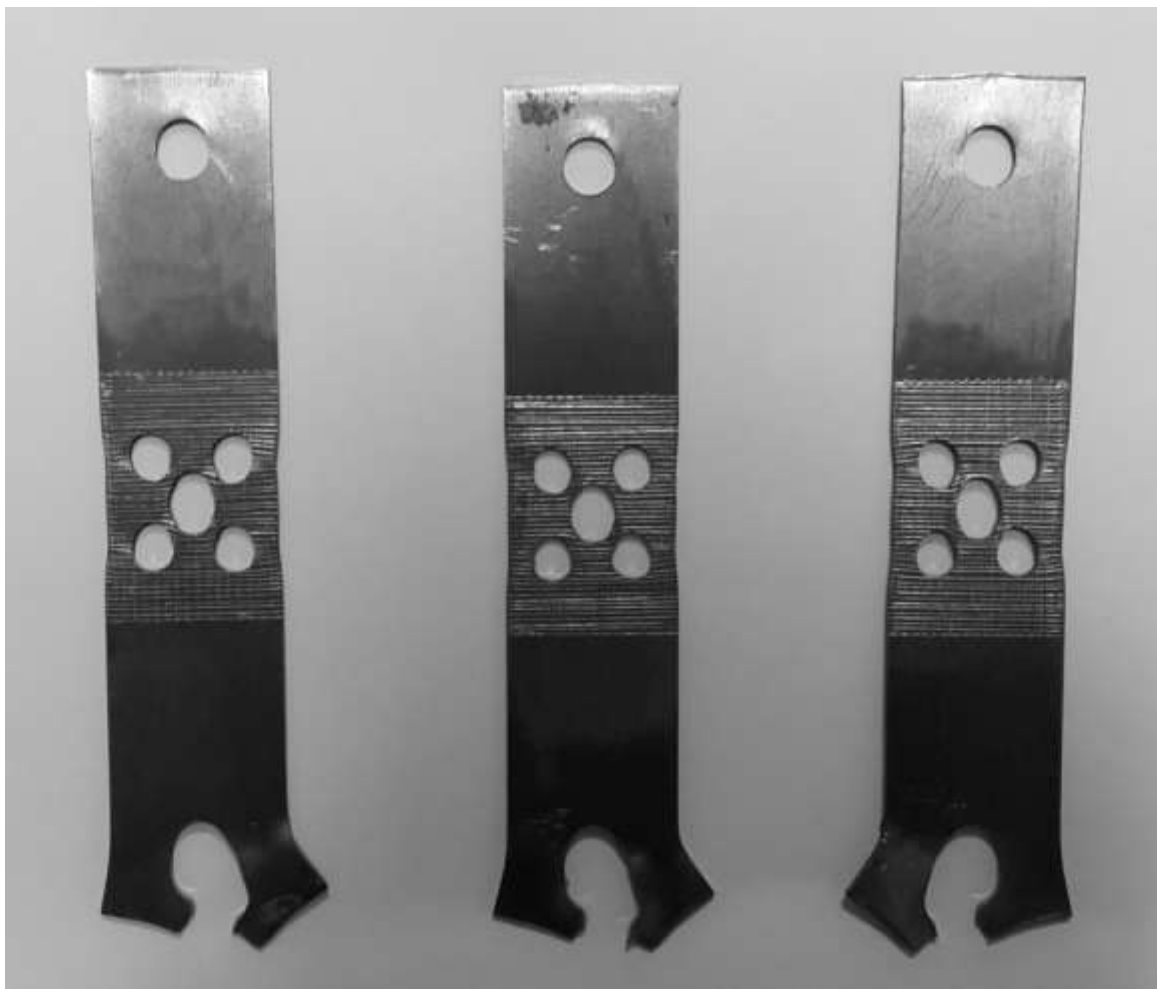
Рис. 4.26. Пластини, зруйновані після 4-х циклів навантаження
