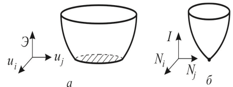
Рис. 1. Вигляд функціоналів: а – повна внутрішня енергія; б – додаткова енергія
