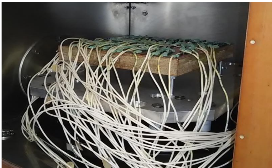
Рисунок 3.10 – Текстолітова пластина з датчиками в термокамері
