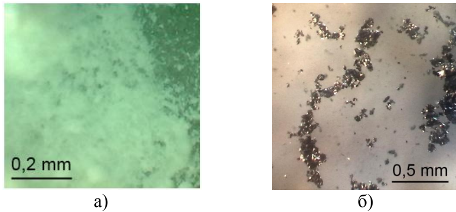
Рис. 1 Розподіл часток дисперсної фази у вакуумній оливі: а) – додавання у оливу масляної фарби; б) – додавання у оливу алюмінієвої пудри
