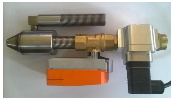
Рисунок 4 – Дослідний зразок гідровихрової форсунки
