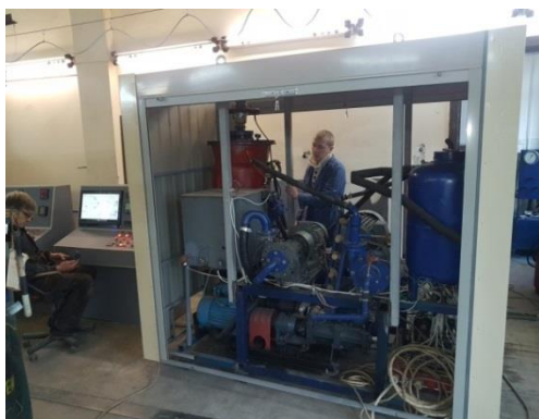
Рисунок 10 – Мобільний експериментальний енерготехнологічний комплекс для проведення досліджень процесів створення та спалювання ШКРП
