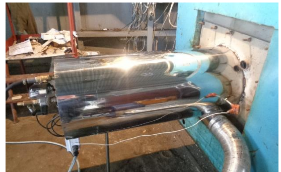
Рисунок 8 – Дослідний зразок пального пристрою, який встановлено на паровому котлі Е-1,0-0,9Г-3(Е)
