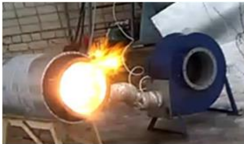
Рисунок 2.35 – Фізичне моделювання процесів спалювання композиційного палива з високим вмістом водної фази
