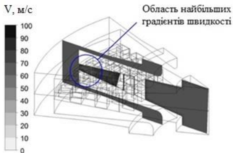
Рисунок 2.23 – Розподілення розрахункової швидкості течії оброблюваної рідини в вертикальному перерізі камери обробки ГКП
