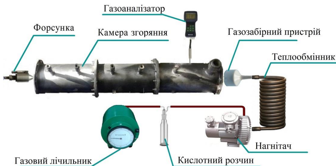
Рисунок 4.15 – Принципова схема системи відбору проб димових газів при спалюванні композиційного палива
