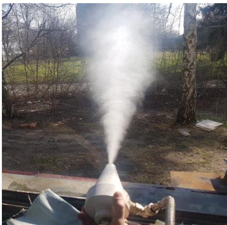
Рисунок 2.10– Фізичне моделювання процесу розпилювання композиційного палива
