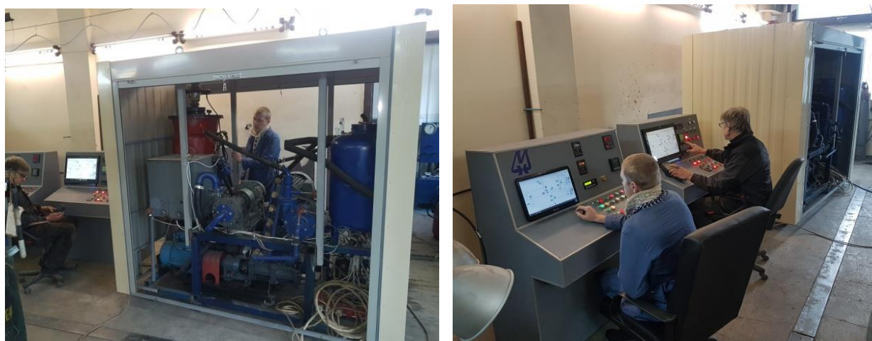
Рисунок 3.4 – Мобільний експериментальний енерготехнологічний комплекс для проведення досліджень процесів створення та спалювання композиційних палив
