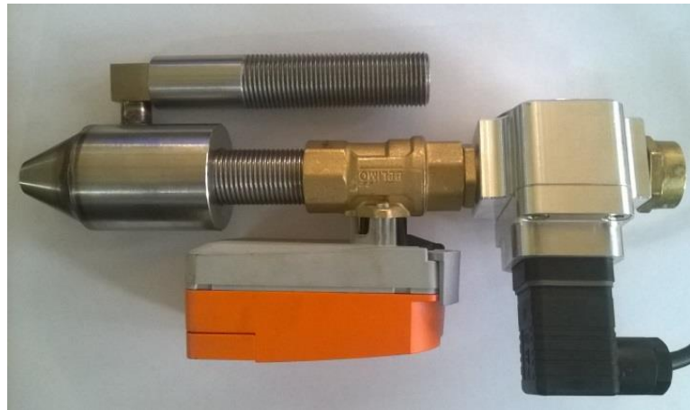
Рисунок 2.11 – Дослідний зразок гідровихрової форсунки
