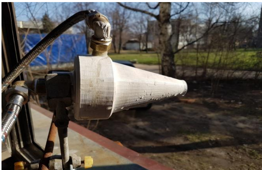
Рисунок 2.9 – 3-D модель гідровихрової форсунки
