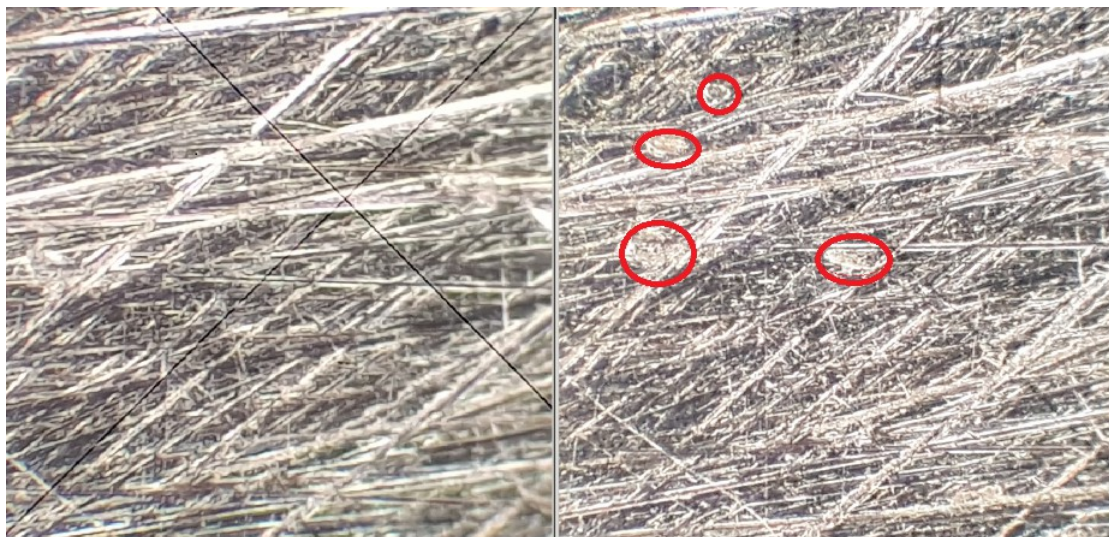
Рис. 2. Зразок до (зліва) та після 40 годин кавітаційного впливу (справа)
