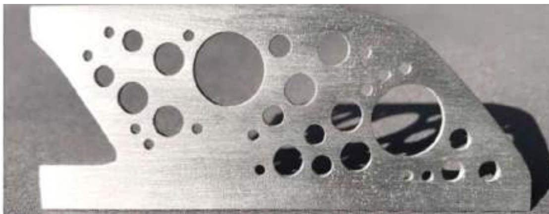
Рис. 6.29. Деталь, надрукована за допомогою 3D-принтера
