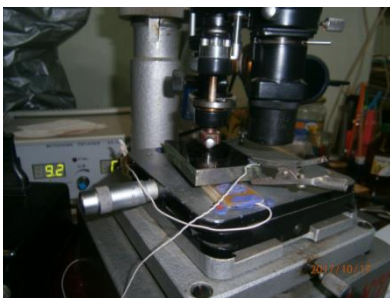
Рис. 17 Випробувальна установка для індентування зразків лопаткової сталі в електричному полі
