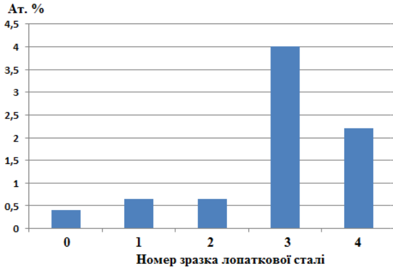
Рис. 8 Вміст водню в зразках сталі
