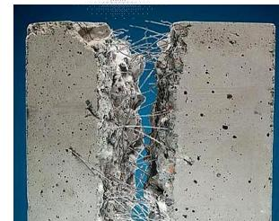
Рис. 1. Структура фібробетону:
