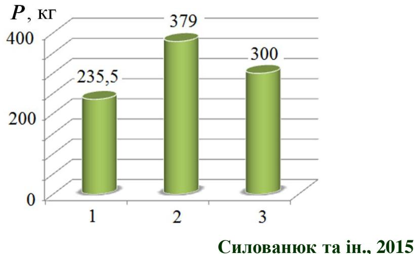
**Середнє значення енергетичного показника  $E_{WT}$  сигналів АЕ під час руйнування неармованого цементного каменю та фіробетону**
