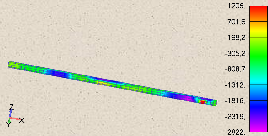
Распределение главных сжимающих напряжений в оси
