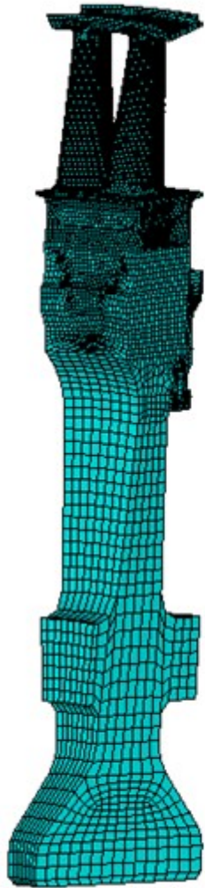
Модель періода робочого колеса ТВТ з попарно бандажованими лопатками
