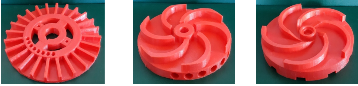
Рис. 7. Макети коліс відцентрових насосів, виконані на 3D-принтері
