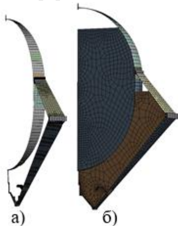
Рис. 4. Скінченно-елементні моделі бака з двома відсіками
