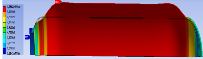
Рис. 14. Максимальне еквівалентне напруження при тиску 27,45 МПа
