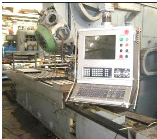
Рис. 4.4. Верстат ФП-7СМН5 після модернізації з системою ЧПУ АВІ.04
