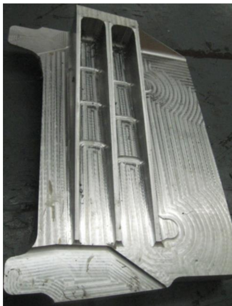
Рис. 4.9. Виготовлений серійний кронштейн 148.00.1001.003.000 на верстаті ФП-7СМН5 після його модернізації
