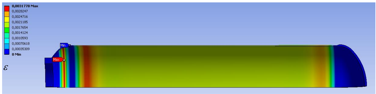
Рис. 3.20. Еквівалентна пластична деформація при тиску 22,24 МПа
