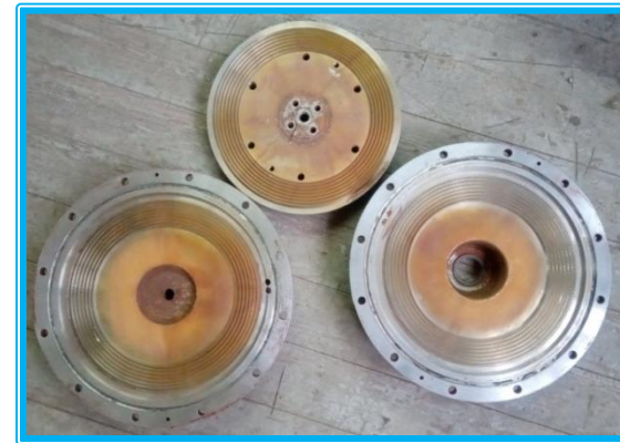
Робочі органи гідрокавітаційного пристрою для обробки рідин низької в'язкості
