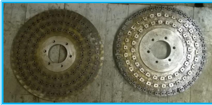
Зносостійкі робочі органи гідрокавітаційного пристрою для створення композиційних палив з наявністю твердої фази
