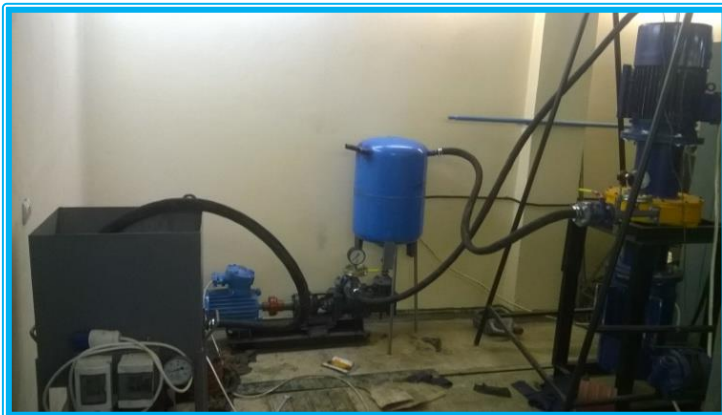
Дослідні зразки гідрокавітаційних пристроїв для виготовлення композиційних палив різного компонентного складу
