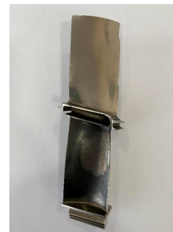
Двоярусна лопатка авіаційного двигуна
