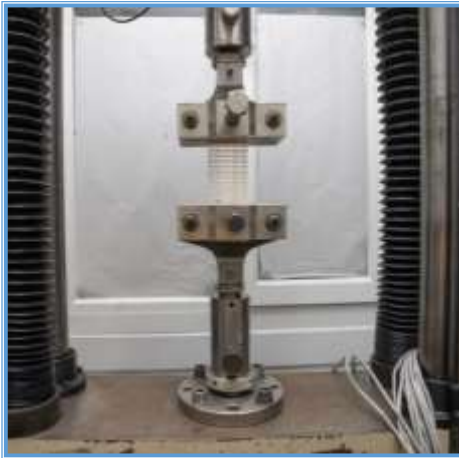
Зразок стільникового заповнювача в затискачах розривної машини
