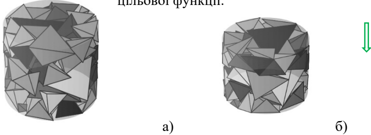
Рис. 1. Оптимізовані компоновки: а) оригінальних багатогранників, h^* = 6.69 ; б) м'яких багатогранників, h^* = 6.24 .
