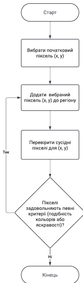
Рис. 1.4. Блок-схема алгоритму зростання регіонів
