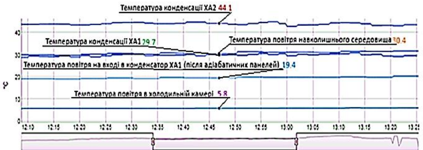
Рис. 8. Показники роботи холодильних агрегатів з адіабатичним охолодженням повітря на вході в конденсатор та без нього
