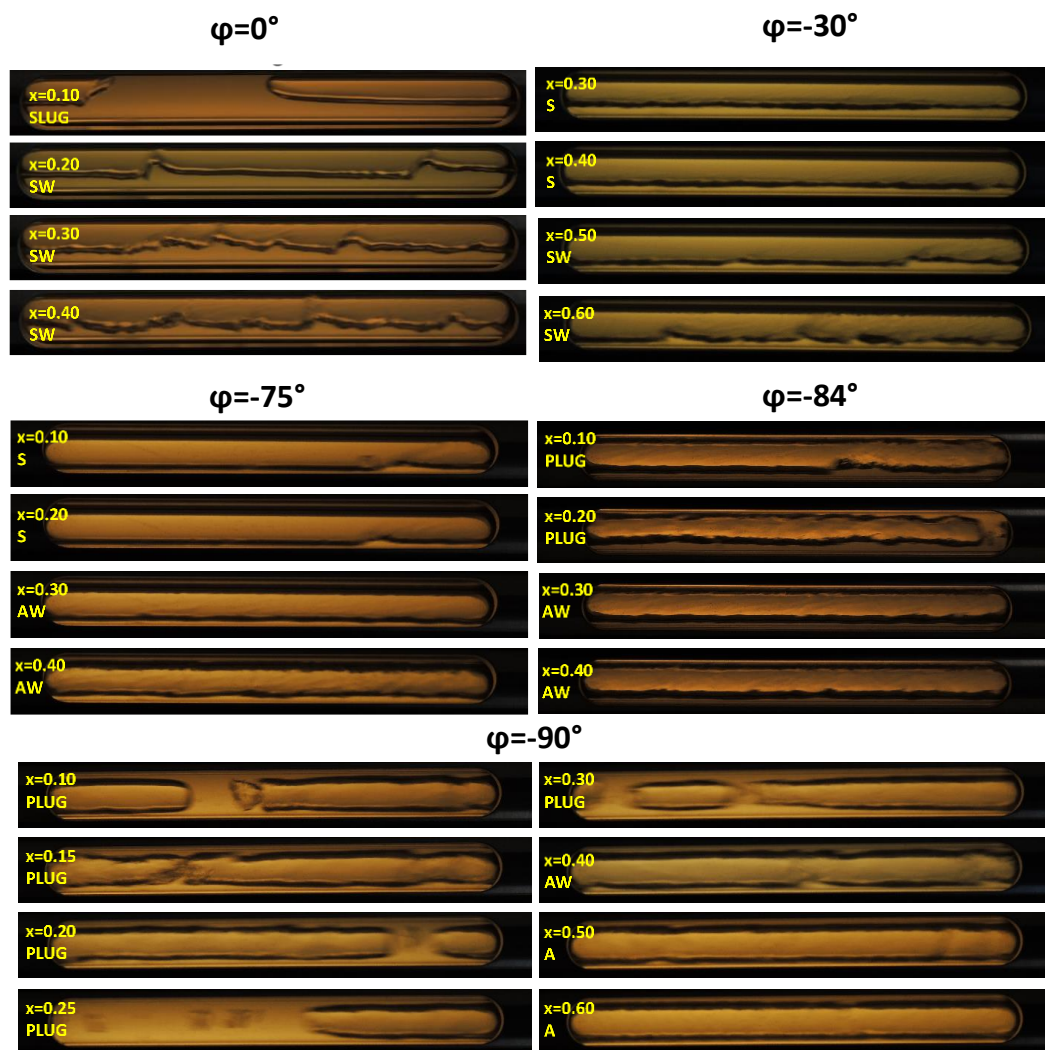
Рисунок 2.15 – Низхідний похилий потік при G = 80 \text{ кг} \cdot \text{м}^{-2} \cdot \text{с}^{-1} і T_s = 55^\circ \text{C}
