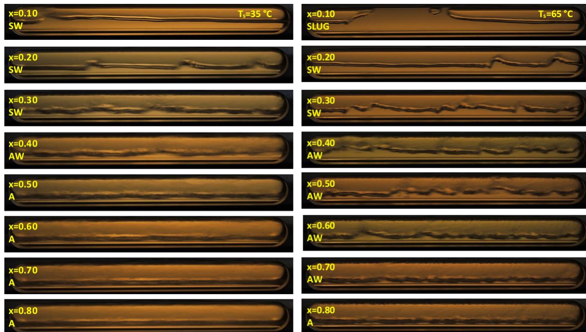
Рисунок 2.3 – Результати випробувань для аміаку при T_s = 35^\circ\text{C} і 65^\circ\text{C} та G = 100 \text{ кг}\cdot\text{м}^{-2}\cdot\text{с}^{-1} . SW - стратифіковано-хвильовий; SLUG – снарядний; AW - кільцево-хвильовий; A - кільцевий
