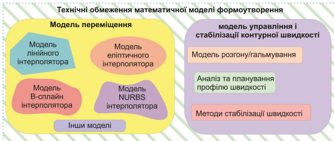
Рис. 1.6. Склад моделі процесу формоутворення при ВШО
