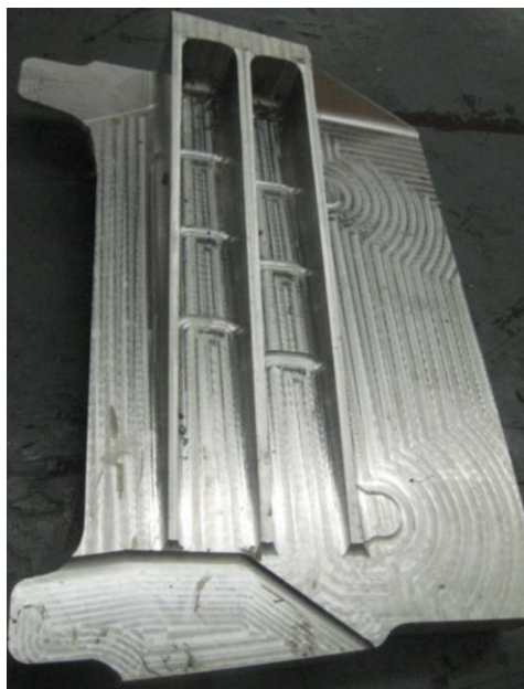
Рис. 4.9. Виготовлений серійний кронштейн 148.00.1001.003.000 на верстаті ФП-7СМН5 після його модернізації
